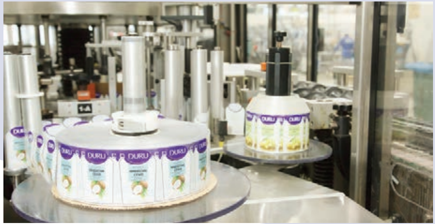
Sıvı sabunların, otomatik ve kapalı dolum sistemi ile 300 ml Duru şişelerine dolumu yapılıyor.
